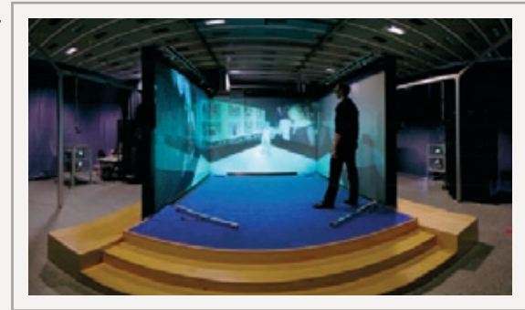
< APPLICAZIONI SPECIALI RETROPROIEZIONE Grazie all'uso dei pannelli ISOLITE®, di un sistema laser e di una triplice retroproiezione, si possono ottenere proiezioni con effetto tridimensionale. SPECIAL APPLICATIONS BACK PROJECTION Thanks to ISOLITE® panels, a laser system and a three sided -back projection, it is possible to obtain three-dimensional effect projections.
