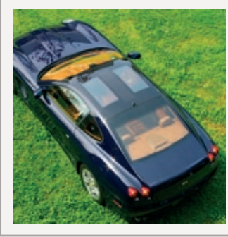
< Ferrari 612 Scaglietti "K" by Pininfarina. Il tettuccio comprende due sezioni di ISOLITE® Ferrari 612 Scaglietti "K" by Pininfarina. The sunroof includes two ISOLITE® sections.
